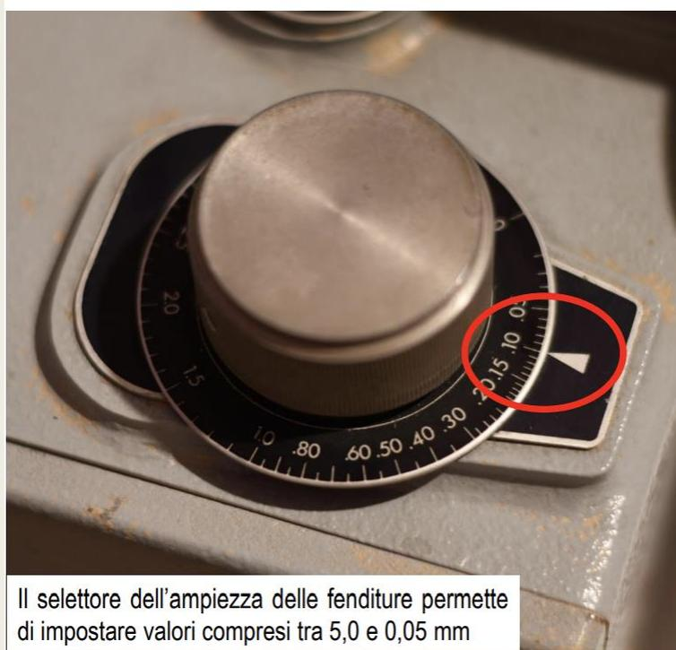
L'**ampiezza delle fenditure** ha effetto sulla **risoluzione** spettrale che si ottiene e sulla **quantità di luce** (intensità luminosa) del fascio in uscita dal monocromatore.
