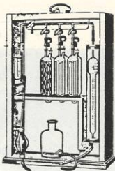
Fig. 4 - Apparecchio di Orsat.
