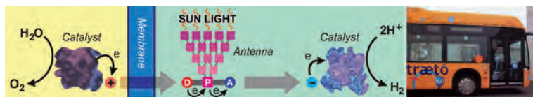
Figura 2: Fotosintesi artificiale per la scissione dell'acqua in idrogeno e ossigeno
